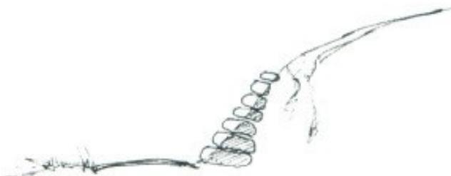
Κατασκευή για αποφυγή διάβρωσης
